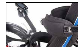
Pelotten mit Ratschen zum Fixieren im Becken- und Brustbereich.
