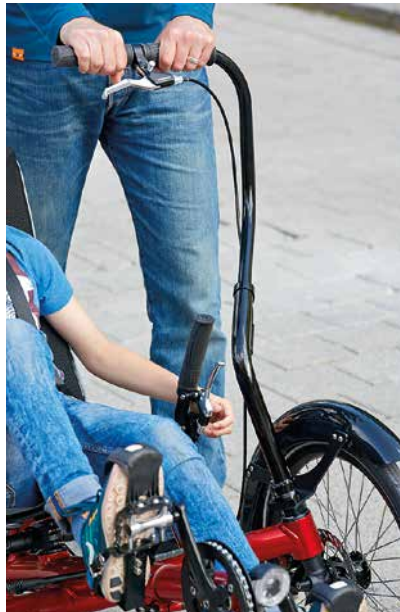
Der stabile Begleitergriff ermöglicht Mitlenken, Beschleunigen und auch aktives Bremsen.
