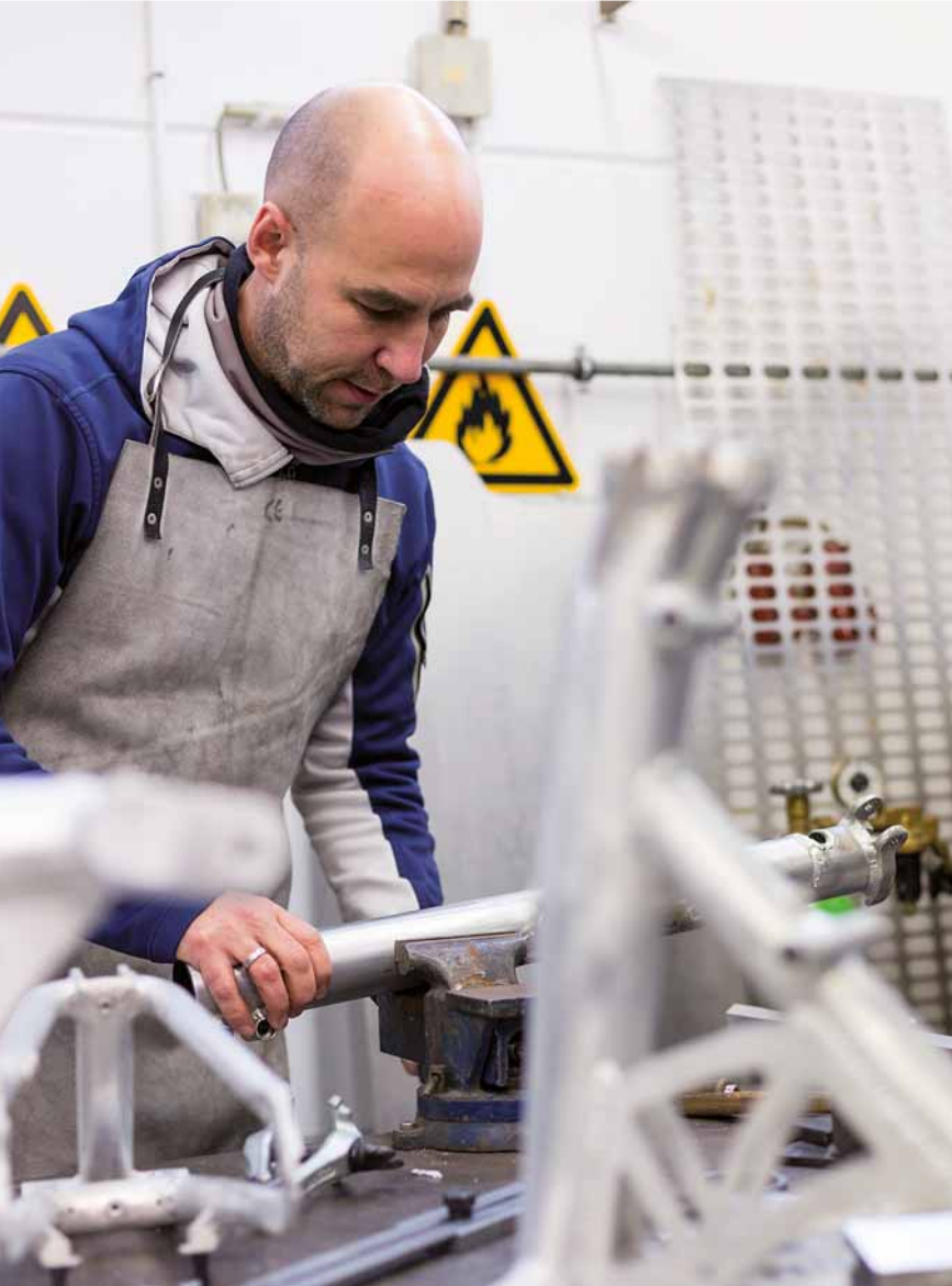
Beim Bau von Prototypen legt Geschäftsführer Daniel Pulvermüller selbst Hand an. Die Serienrahmen aus hochfestem Aluminium werden bei spezialisierten Partnerbetrieben geschweißt.
