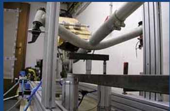
Eigene, computergesteuerte Prüfstände für Betriebsfestigkeitsprüfungen von Bauteilen.
