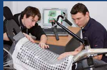
Analyse der Druckverteilung am BodyLink-Sitz mit dynamischer Belastungsmessung.
