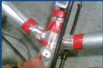
Messung von realen Fahrbelastungen per DMS für FEM-Analysen im 3D CAD-Modell.
