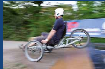
Überlastprüfungen bei Fahrversuchen in Extremsituationen.
